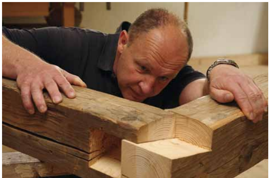
Mit dem Stechbeitel werden die alten Balken bearbeitet. Sie erhalten Schlitz und Zapfen, die später miteinander verbunden werden. Nach und nach entsteht so ein solides Bett.
