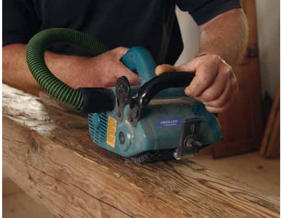
Das Holz wird mit der Maschine abgebürstet, um allen Staub und Schmutz zu entfernen. Die Risse im Holz werden mit Schleifpapier bearbeitet, damit man nicht daran hängen bleibt.
